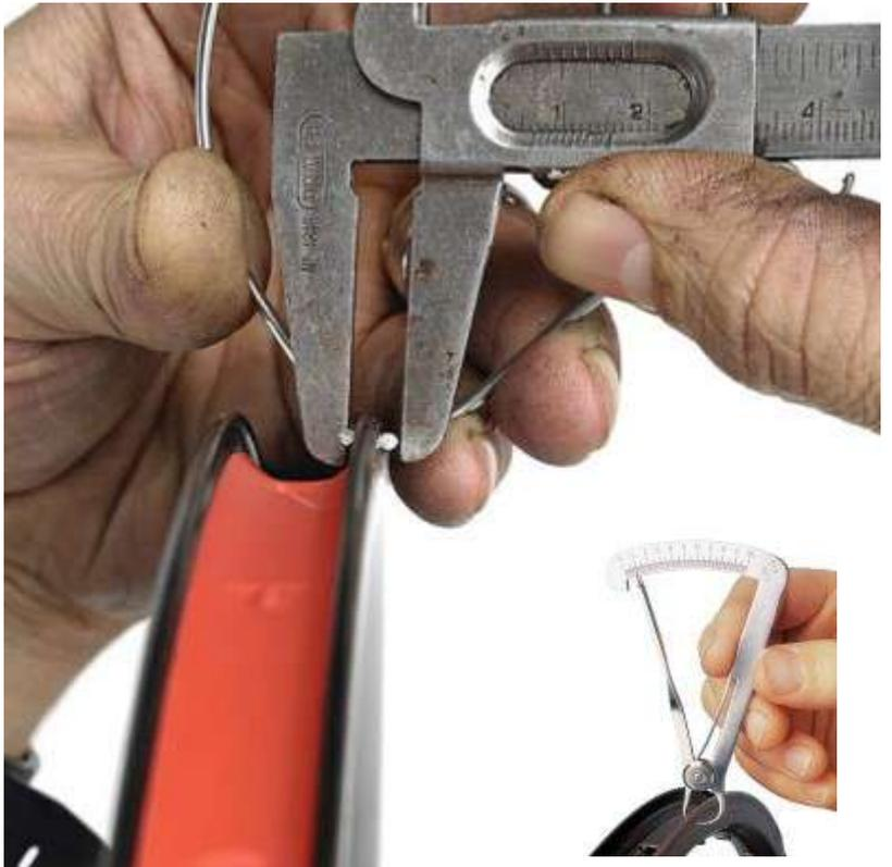
Si l'épaisseur de la paroi de la jante est inférieure à 0,9 mm, la jante doit être immédiatement remplacée. L'usure dépend des conditions de roulage. La saleté s'incrustant entre les patins de frein et la jante peut influencer la durée de vie ainsi que les performances de freinage.
