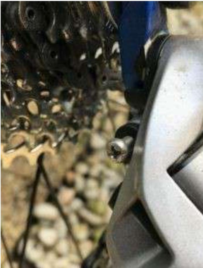
La vis T sert au réglage de la position « verticale » du dérailleur ou plutôt de sa chape.
