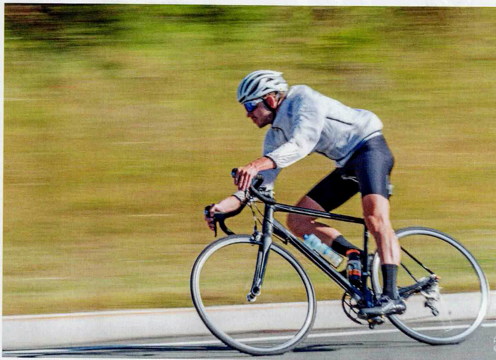
Cet équilibre vertical de la bicyclette est favorisé par l'effet gyroscopique des roues dont la rotation rapide maintient et ramène la roue en position verticale.
